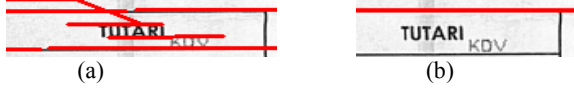
Şekil 2. (a) Doğru bulma yöntemi ile elde edilen kesik doğrular. (b) Doğruların düzgünleştirilmiş hali
